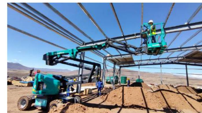
Благодаря полноприводной системе, высокой мощности, а также специальному шасси с плавающей осью, подъёмники способны преодолевать сложные дорожные условия.
